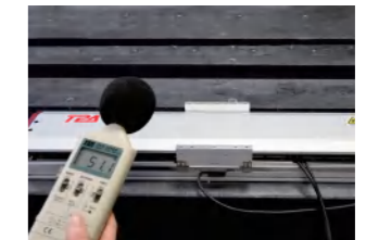
9. 模组运行噪音检测。 Running noise detection of module.
