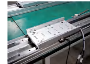
8. 通电测试。 Power-on test.
